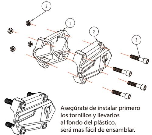
Asegúrate de instalar primero los tornillos y llevarlos al fondo del plástico, será más fácil de ensamblar.
